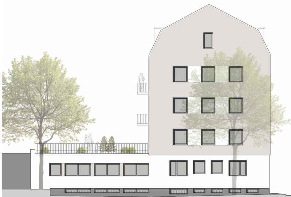
Seitenansicht Am Römerturm 7 nach Aufstockung Dachgeschoss
